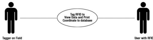
Gambar 3. 5 Use Case Diagram Sistem Slave Sistem Slave yang diilustrasikan pada use-case diagram pada Gambar 3.5 terdiri dari tagger yang memiliki RFID tag pada koordinat-koordinat yang telah ditentukan untuk melakukan pengecekan pada RFID yang dimiliki oleh user (pemilik kendaraan sepeda
