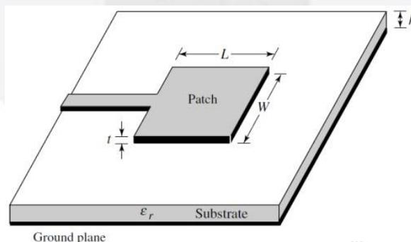
Gambar 2 Struktur Antena Mikrostrip<sup>[2]</sup>
