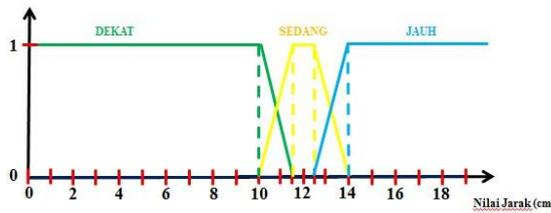
Gambar 3.2 Fungsi Keanggotaan Tiga Buah Sensor Jarak Ultrasonik
