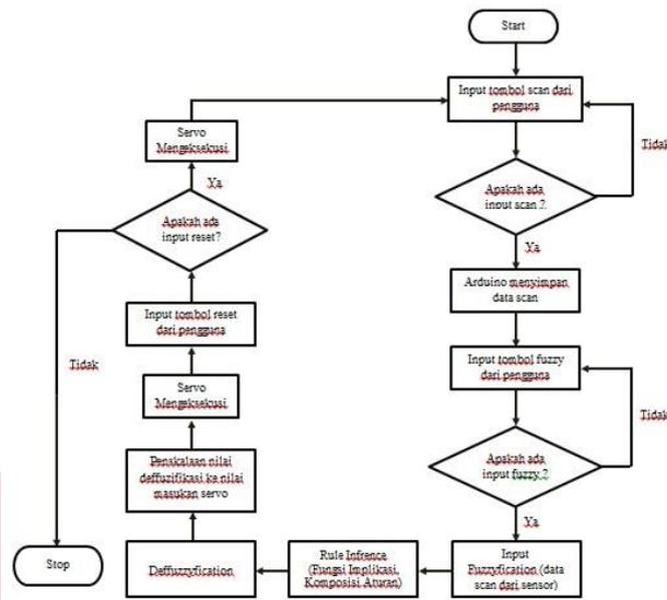
Gambar 2.5 Flowchart Sistem Robot Penggenggam
