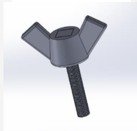
Gambar 2 Baut Handle Pada Toolpost
