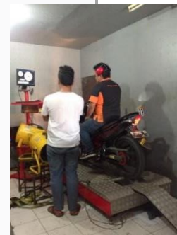
Gambar 6 Pengukuran Jupiter MX menggunakan dynotest existing
