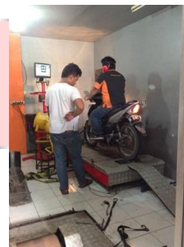
Gambar 5 Pengukuran Revo menggunakan dynotest existing
