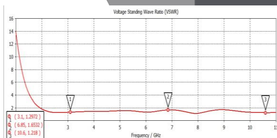
Gambar 7 (a) Grafik VSWR Pada Frekuensi ( 3.1 – 10.6) GHz, (b) VSWR Antena pada Frekuensi (3.1-10.6) GHz saat Berada Pada Phantom/Tubuh Manusia Sejah 2 mm
