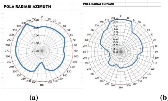
**Gambar 10 Perbandingan Pola Radiasi Saat Simulasi dan Pengukuran Pada Frekuensi 6.85 GHz**
