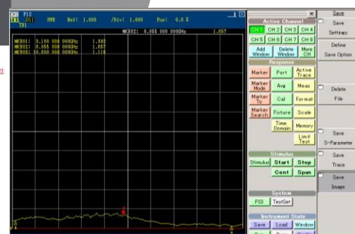
Gambar 7 (a) Grafik VSWR Pada Frekuensi ( 3.1 – 10.6) GHz, (b) VSWR Antena pada Frekuensi (3.1-10.6) GHz saat Berada Pada Phantom/Tubuh Manusia Sejah 2 mm
