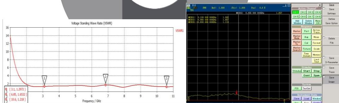
**Gambar 7 (a) Grafik VSWR Pada Frekuensi ( 3.1 – 10.6 ) GHz,(b) VSWR Antena pada Frekuensi (3.1-10.6) GHz saat Berada Pada Phantom/Tubuh Manusia Sejauh 2 mm**
