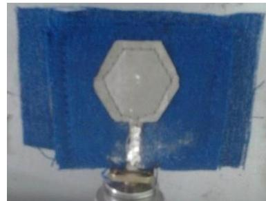
**Gambar 5 Realisasi Antena Tekstil Body Centric**
