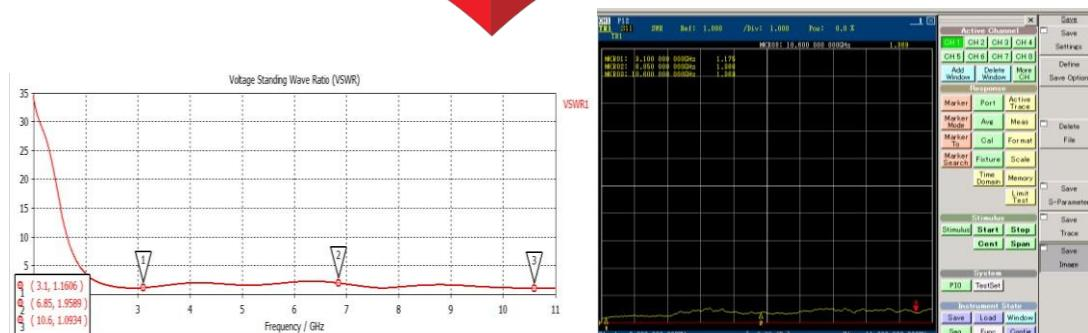
**Gambar 6 (a) Grafik VSWR Pada Frekuensi ( 3.1 – 10.6 ) GHz di Free Space,(b) VSWR Antena pada Frekuensi (3.1-10.6) GHz saat Free Space**
