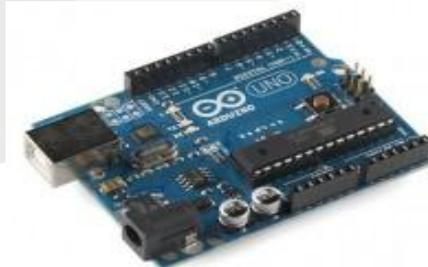
Gambar 2.2 Arduino UNO<sup>[5]</sup>
