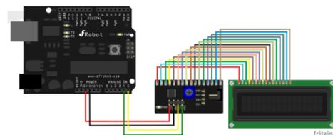
Gambar 3.6 Perancangan LCD 2x16
