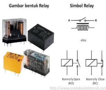
**Gambar 2.3** Gambar dan simbol Relay<sup>[4]</sup>
