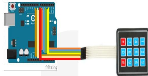
Gambar 3.5 Perancangan Keypad 3x4
