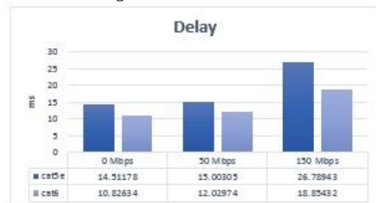
Gambar 4.4 Delay Kabel UTP cat5e dan cat6
