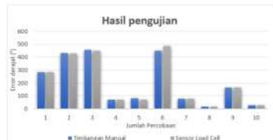
Grafik 4. 1 Pengujian sensor load cell
