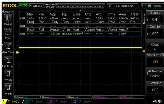
Gambar 4.2 Hasil pengujian Three Phase Rectifier dengan kapasitor
