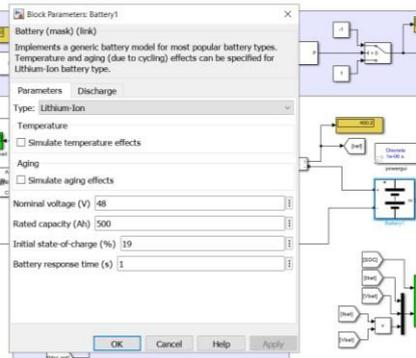
Gambar 8 Parameter Baterai Lithium Ion
