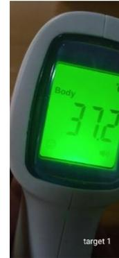
Pada gambar diatas menunjukkan bahwa suhu yang dideteksi thermogun pada target pertama ialah 37,2°C berbeda dengan menggunakan kamera termal maupun menggunakan histogram. Perbedaan antara suhu thermogun, kamera termal, data histogram adalah selisih 0,2°C pada masing-masing percobaan.
