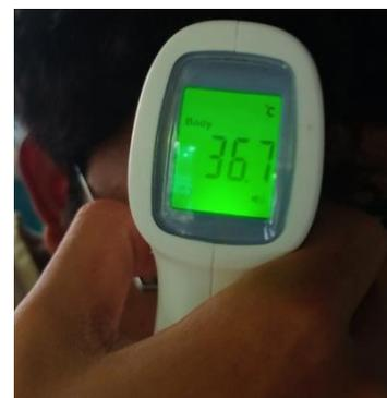
Pada gambar diatas pengukuran suhu menggunakan thermogun pada target ketiga terdeteksi suhu sebesar  $36,7^{\circ}\text{C}$ . Hasil dari thermogun tersebut berbeda dengan hasil yang didapat pada kamera termal. Kamera termal mendeteksi suhu target ketiga sebesar  $37,1^{\circ}\text{C}$  sedangkan suhu histogram hampir sama dengan suhu kamera termal yaitu di  $37,11^{\circ}\text{C}$ .
