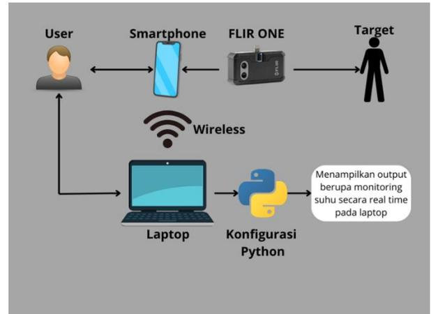
Cara kerja sistem yang diusul ialah apabila FLIR ONE sudah terhubung ke perangkat smartphone, maka hubungkan smartphone dengan jaringan yang sama dengan laptop. Setelah kedua perangkat sudah terhubung dengan wifi yang sama, kami menggunakan screen mirroring agar mendapat tampilan aplikasi FLIR ONE yang berada di smartphone berbasis Android ke perangkat laptop. Dari situlah kami dapat menambahkan kodingan berupa face tracking dengan menggunakan aplikasi pycharm pada perangkat laptop.
