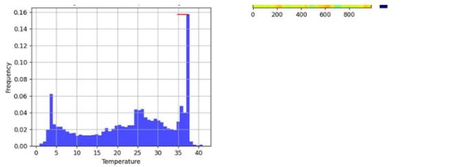
Dapat dilihat pada gambar diatas sumbu ( $x$ =suhu) sedangkan sumbu ( $y$ =frekuensi). Maksud dari frekuensi dalam histogram ini ialah banyaknya muncul pixel pada daerah tertentu pada gambar. Pada Gambar 4.8 pengguna ingin melihat suhu tertinggi atau pixel berwarna merah pada thermal image. Dan didapatkan suhu berkisar  $37,1^{\circ}\text{C} - 37,9^{\circ}\text{C}$  dengan frekuensi keluaran pixel di 0,1566.
