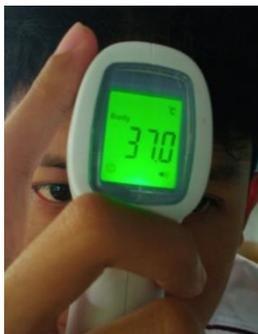
Pada gambar diatas thermogun mendapatkan hasil  $37^{\circ}\text{C}$  pada target kedua. Berbeda dengan hasil pada aplikasi FLIR ONE yang mendapatkan suhu  $38,1^{\circ}\text{C}$  dan histogram yang mendapat suhu kisaran  $37,1^{\circ}\text{C} - 37,9^{\circ}\text{C}$ .
