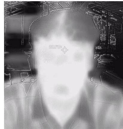
Pada gambar diatas pengukuran suhu target kedua dengan menggunakan aplikasi FLIR ONE mendapatkan suhu 38,1°C. Dengan kondisi ruangan outdoor yang bersuhu kisaran 30°C - 33°C.
