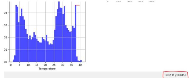
Pada gambar diatas pengguna ingin melihat suhu tertinggi atau pixel berwarna merah pada thermal image. Dan didapatkan suhu sebesar  $37,11^{\circ}\text{C}$  dengan frekuensi keluaran pixel di 0,0464.
