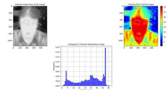
Gambar diatas adalah tampilan dari matplotlib yang didalamnya terdapat citra grayscale asli gambar, thermal image, dan histogram. Pengguna dapat melihat suhu target pada bagian cropped thermal image dan histogram.
