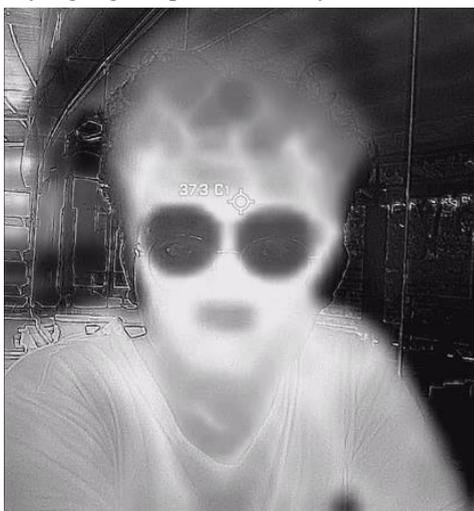
Pada gambar diatas didapatkan hasil pengukuran suhu dari aplikasi FLIR ONE pada target ketiga adalah  $37,3^{\circ}\text{C}$ . Dengan kondisi ruangan outdoor bersuhu kisaran  $30^{\circ}\text{C} - 33^{\circ}\text{C}$ .
