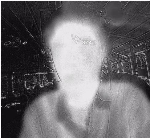
Pada gambar diatas pengukuran suhu menggunakan aplikasi FLIR ONE, diambil data dari jarak 95cm dengan kondisi ruangan yang bersifat outdoor. Hasil pengukuran menunjukkan suhu pada dahi target sebesar 37,4°C.
