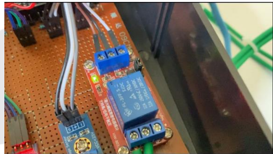
GAMBAR 9. Relay Saat Posisi Mati
