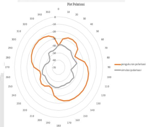
**Gambar 10.** Hasil polarisasi pada pengukuran dan simulasi
