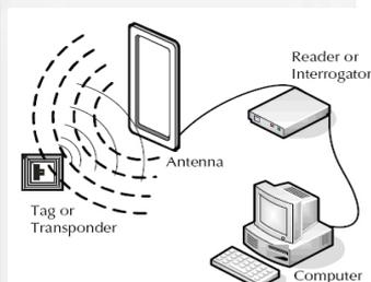
Gambar 2. Sistem RFID
