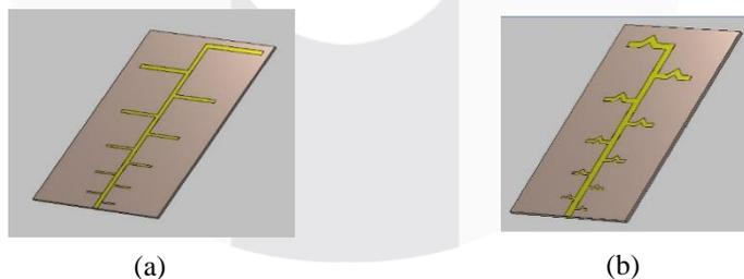
**Gambar 3.1** Antena cetak LPDA 11elemen (a) tanpa fractal Koch, (b) dengan fractal koch
