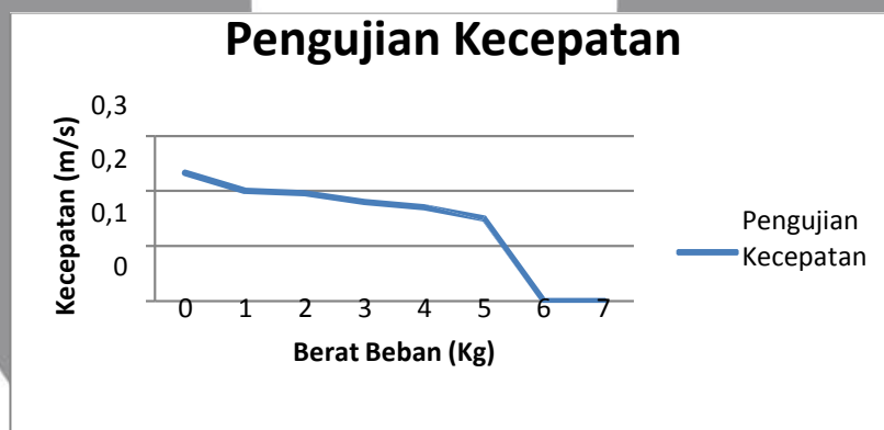
Gambar 1.3 Pengujian Akurasi Kecepatan Gerak Alat
