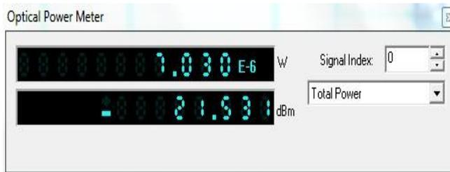
**Gambar 4.5 Nilai Link Power Budget untuk downstream**
