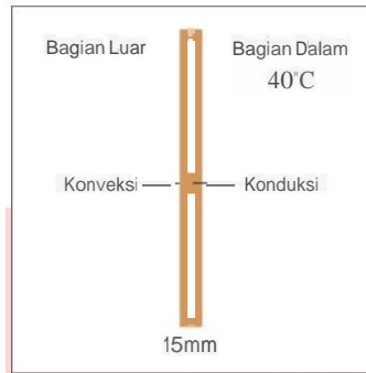
Gambar 3.4. Proses perpindahan panas konduksi dan konveksi pada salah satu sisi triplek
