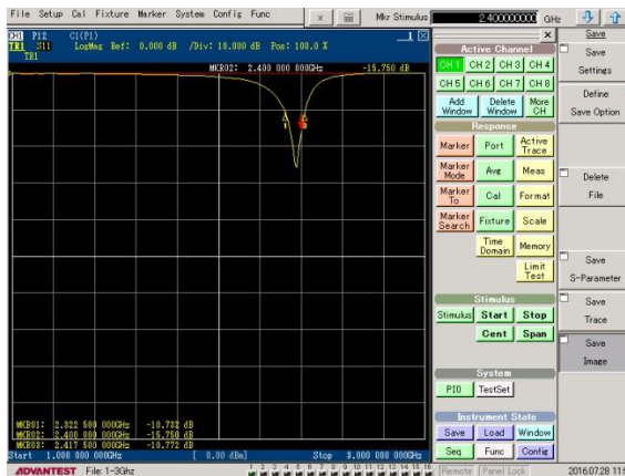
Gambar 4.1 Grafik Pengukuran Return Loss
