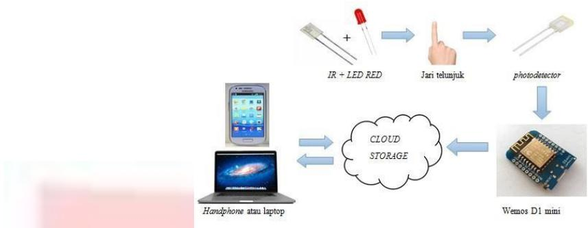
Gambar 3.2 Gambaran kinerja alat pengukur kadar glukosa
