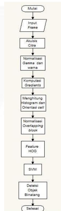
Gambar 5. Alur proses deteksi objek dengan metode *HOG+SVM*
