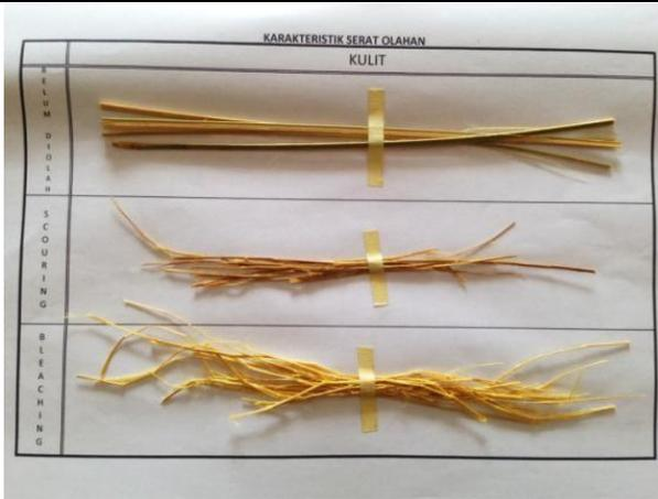
Gambar 2.2 Karakteristik Kulit Bambu
