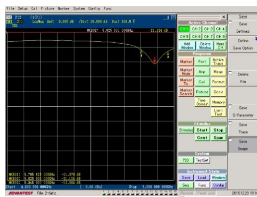
Gambar 10 Hasil pengukuran return loss
