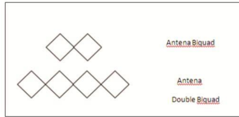
Gambar 4 Bentuk Dasar Antena Biquad dan Biquad Ganda
