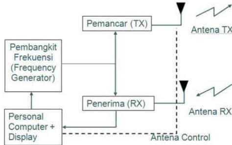
Gambar 2.1 Blok diagram Radar FM-CW yang dikembangkan oleh PPET-LIPI<sup>[8]</sup>
