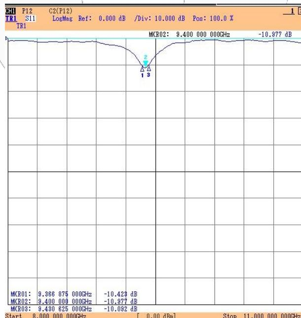
**Gambar 4.1** Hasil pengukuran *Return loss* (S11)
