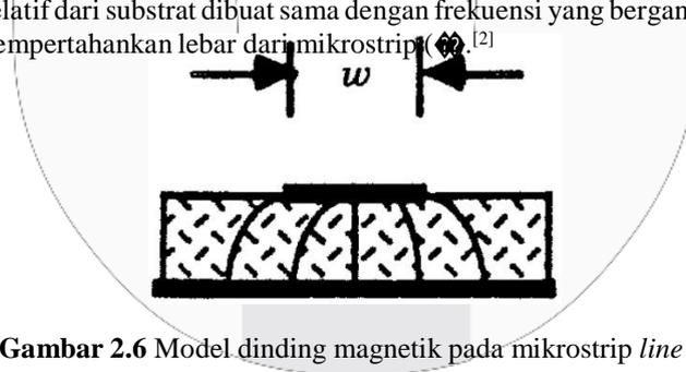
Gambar 2.6 Model dinding magnetik pada mikrostrip line [2]
