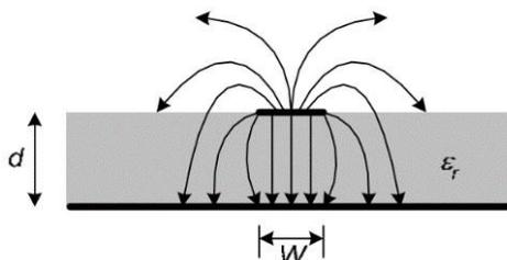
Gambar 2.3 Saluran Mikrostrip <sup>[2]</sup>
