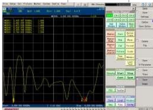
Gambar 3.1 Grafik Pengukuran VSWR dan Bandwidth
