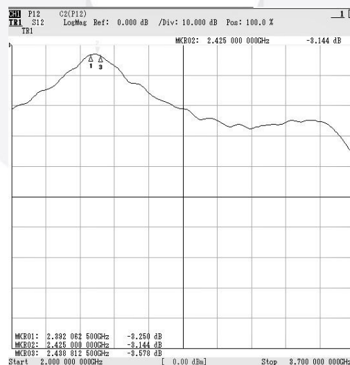
Gambar 8. Hasil pengukuran Insertion Loss pada filter
