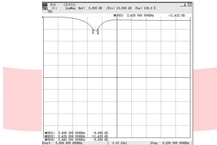
Gambar 7. Hasil pengukuran Return Loss (S11) pada filter
