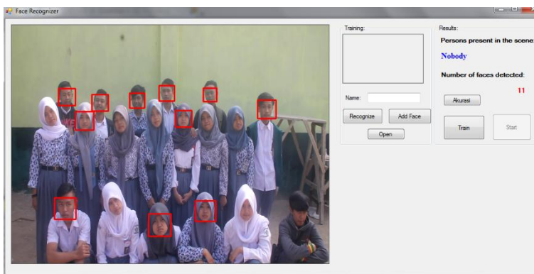
Gambar 2.2 Jumlah wajah yang terdeteksi dengan menggunakan minNeighbor 3 dan scaleFactor 1.1
