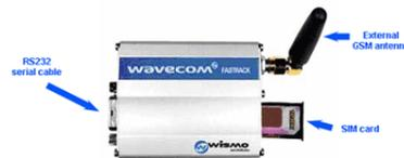
**Gambar 2.2** Wavecom SMS Gateway.
