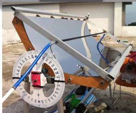
**Gambar 3.3** Pengujian Sudut Kolektor dan Sudut Matahari
