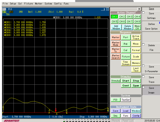
Gambar 3.1 Grafik Pengukuran VSWR dan Bandwidth
