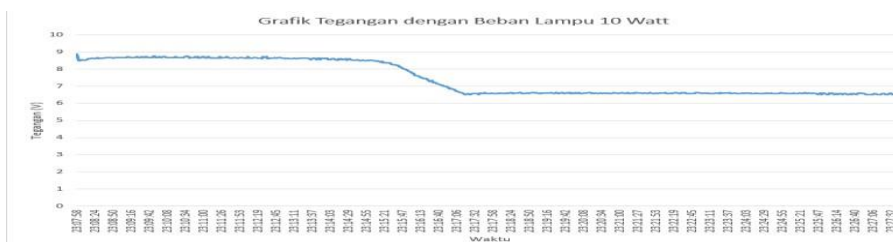
Gambar 4.2 Grafik perubahan tegangan dalam satuan waktu dengan beban lampu 10 watt
