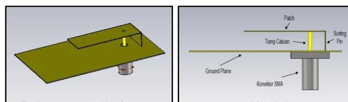
Gambar 5. Antena PIFA single tampak perspektif (kiri) dan samping (kanan)
