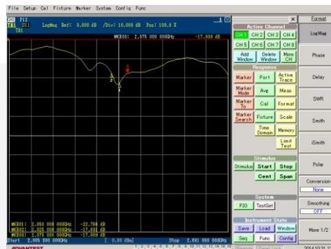
Gambar 8. Grafik *Return Loss* Hasil Pengukuran
