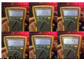
Gambar 5 Pengujian frekuensi keluaran square signal generator
