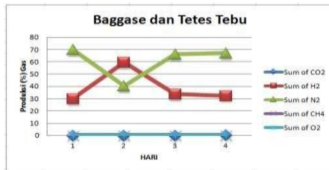
Gambar 3. Grafik hasil gas yang dihasilkan pada baggase tebu dan tetes tebu selama 96 jam (4 hari)
